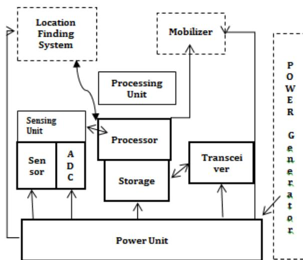
Fig. 1: Sensor Node-Components
