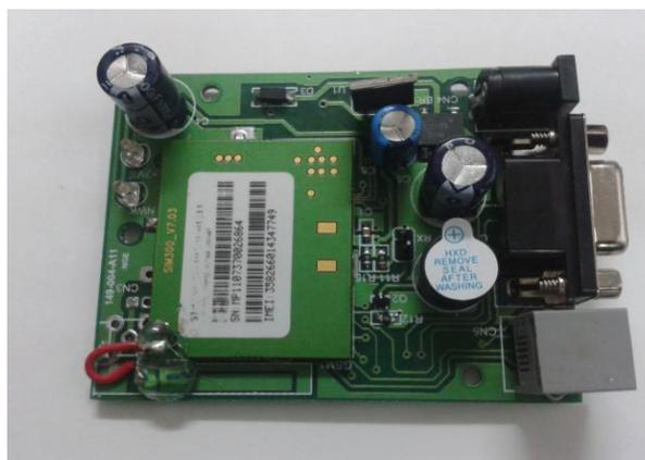
Fig. 4: GSM module
